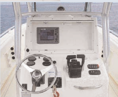
Sopra, la timoneria idraulica servoassistita. Sotto, il sedile a prua che ospita la vasca per il vivo.
