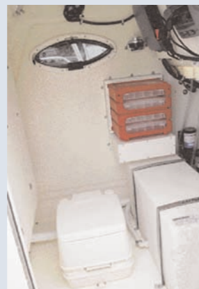
Il volume ricavato sotto la consolle di guida che ospita il wc chimico.
