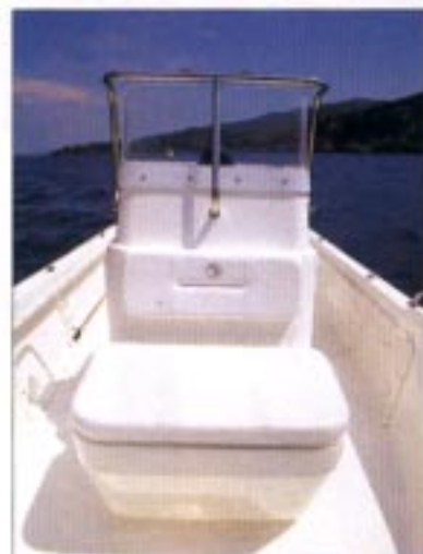
A sinistra, il passavomo tra la consolle di guida e la murata misura 51 centimetri. A destra, la doppia seduta a prua.
