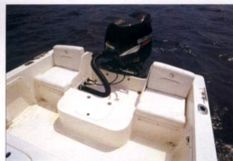
A sinistra, il passavomo tra la consolle di guida e la murata misura 51 centimetri. A destra, la doppia seduta a prua.
