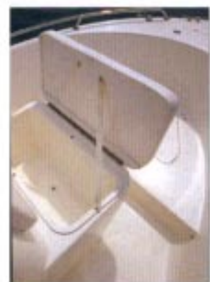
Inglobata nella struttura della consolle di guida si trova una generosa seduta per due persone. Il divanetto, sotto al quale è stato ricavato lo spazio per una ghiacciaia, è largo 80 centimetri e profondo 42.
